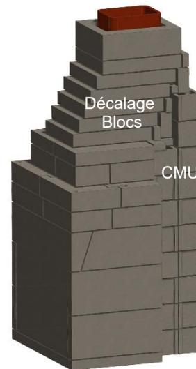
Figure 20. Blocs de décalage et support CMU
