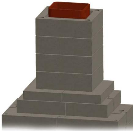
Figure 19. Assemblage de la cheminée de maçonnerie
