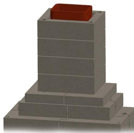
Figura 19. Montaje de la chimenea de mampostería
