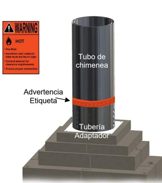
Figura 23. Conectar la chimenea
