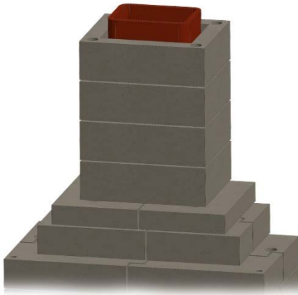
Figure 19. Assemblage de la cheminée de maçonnerie
