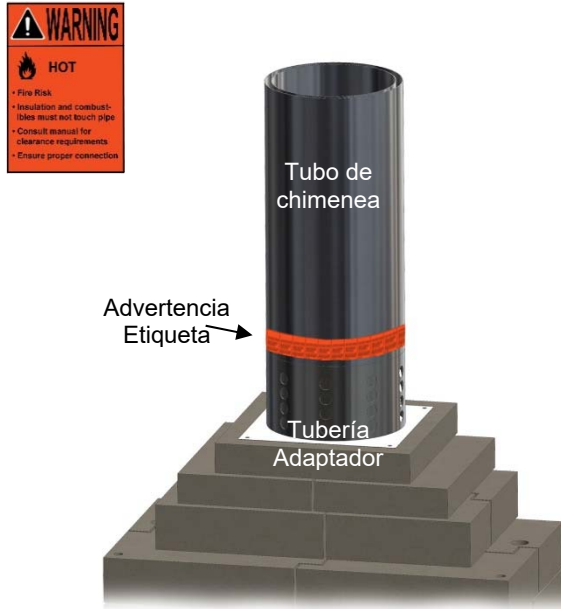
Figura 23. Conectar la chimenea
