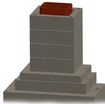
Figura 19. Montaje de la chimenea de mampostería
