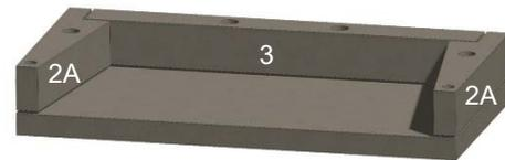
Figure 5. Extensions de la paroi latérale et de la plaque arrière
