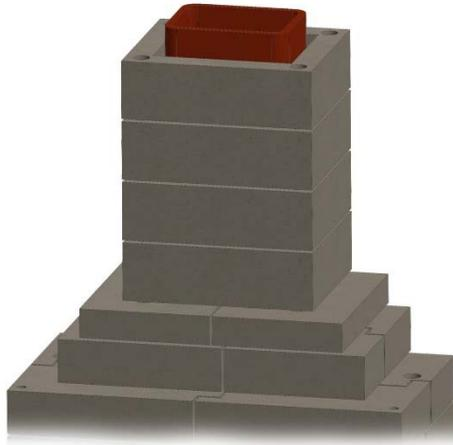
**Figure 20. Assemblage de la cheminée de maçonnerie**
