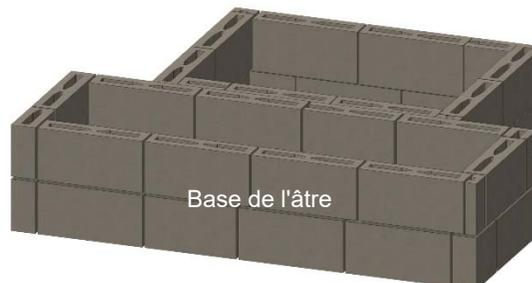
Figure 7. Base de bloc avec foyer
