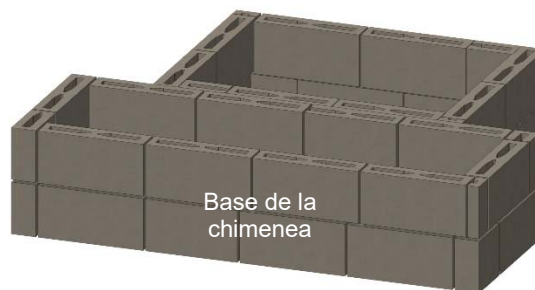
Figura 7. Base de bloque con chimenea
