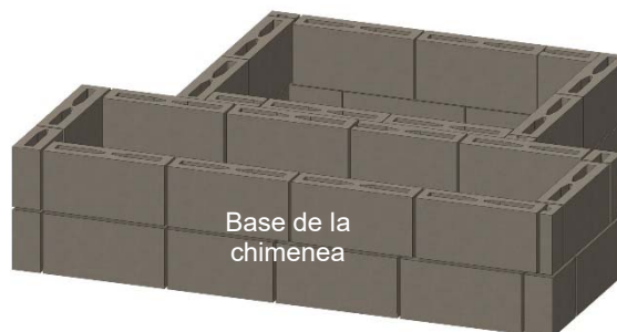
Figura 7. Base de bloque con chimenea
