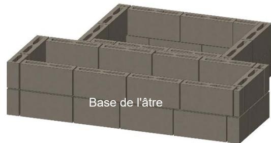
Figure 7. Base de bloc avec foyer
