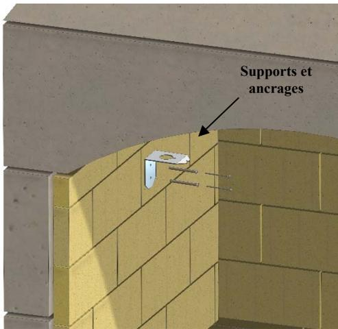
Figure 29. Installer le support et les ancrages
