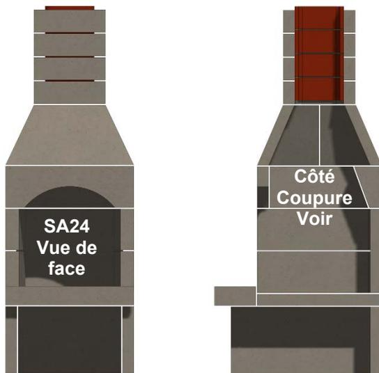
Figure 1. Assemblage du foyer SA24 et vue en coupe
