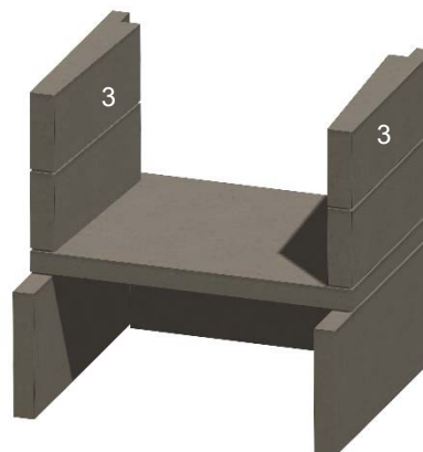
Figura 12. Paredes laterales centrales
