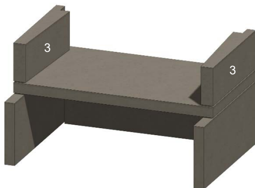
Figure 11. Parois latérales inférieures
