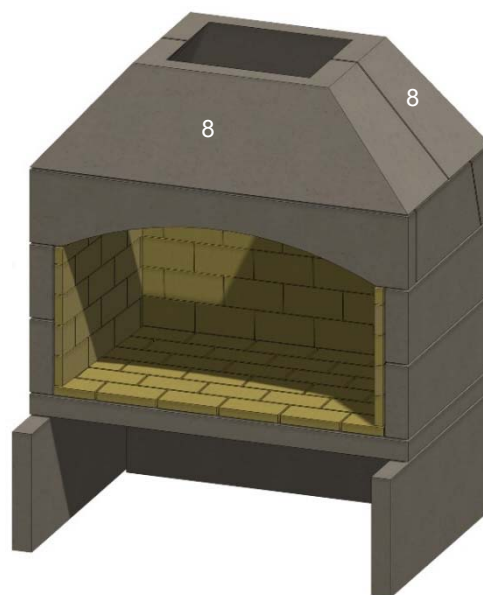
Figura 21. Piezas de la garganta
