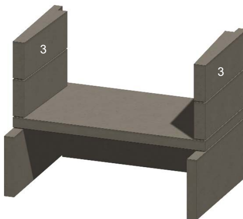
Figura 12. Paredes laterales centrales
